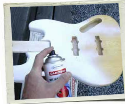
BILD 9: Vi valde att lägga på en matt färg med vit kulör på vår gura. Tänk på att välja lämplig kulör på grundfärgen då den kan lysa igenom efter doppet.
