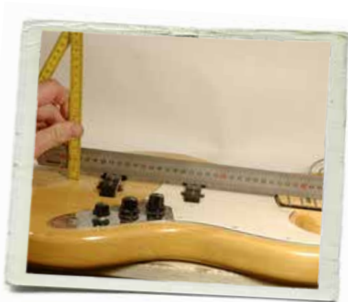
BILD 4: Mät halsvinkeln innan halsen lossas så slipper du en massa justeringar efteråt!
