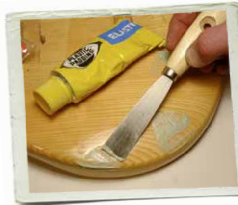
BILD 6: Passa på och spackla igen dings och repor innan du slipar ner originallackens yta till en matt finish.
