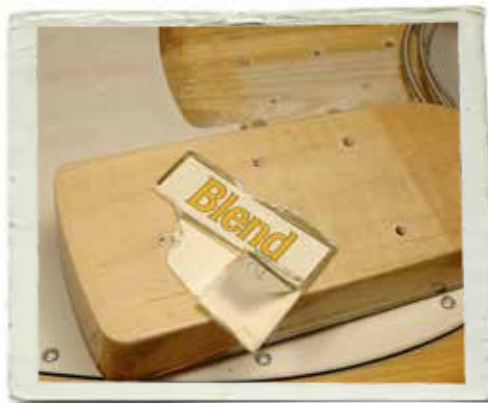
BILD 5: Hm... Det var nästan 20 år sedan jag slutade röka. Shimset i halsfickan bestod av locket till ett cigarettpaket – måste ha varit förra ägaren.
