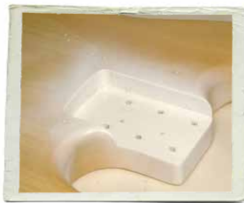
BILD 8: Halsfickan är ofta olackerad. Lägg på några lager grundfärg här innan "handtaget" skruvas dit så suger träet inte åt sig vatten under doppet.
