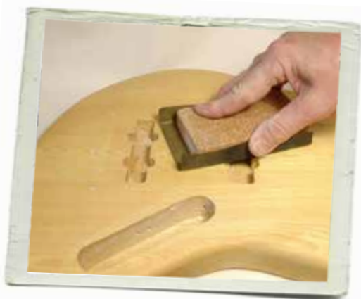
BILD 7: Slipa med ett fint våtslappapper med kornstorlek på 240-400. Blanda en droppe handdiskmedel i vattnet så håller papperet längre. Undvik att drälla för mycket vatten i alla hål.
